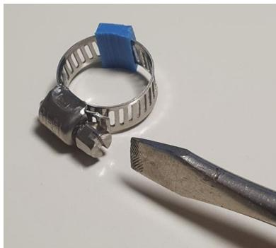
L'anello (7), che si riconosce dal ricevitore azzurro più basso, deve essere collegato al tubo del contatore dal lato dell'impianto come in figura. Se questo non è accessibile, è possibile collegarlo ad un qualsiasi tubo metallico, Aprire prima l'anello svitandolo con un cacciavite a lama piatta o con una chiave a bussola n.6.
